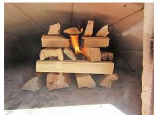
Bitte beachten Sie, dass das Thermometer während der Aufheizzeit zunächst nur die Abgastemperatur anzeigt. Diese kann durchaus bei 450 °C liegen, zeigt jedoch in diesem Stadium noch nicht die tatsächliche Steintemperatur an. Erst nach dem weitgehenden Abbrand des Anzündholzes wird die angezeigte Temperatur realistisch.
