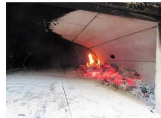
Das Backraumgewölbe ist zunächst schwarz mit Ruß belegt, nach ca. 1-2 Stunden hat der Backraum eine gleichmäßige Temperaturverteilung erreicht und das Gewölbe wird hell. Achten Sie nun darauf, dass das Feuer nicht ausgeht, aber nur mit einer kleinen Menge Holz nachlegen.
